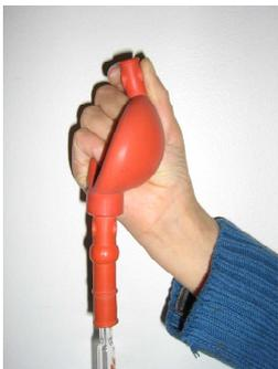
On pince la valve A entre le pouce et l'index, tout en écrasant la poire en caoutchouc avec les trois autres doigts. Dans le cas où la pipette est en place, la tenir avec l'autre main.
