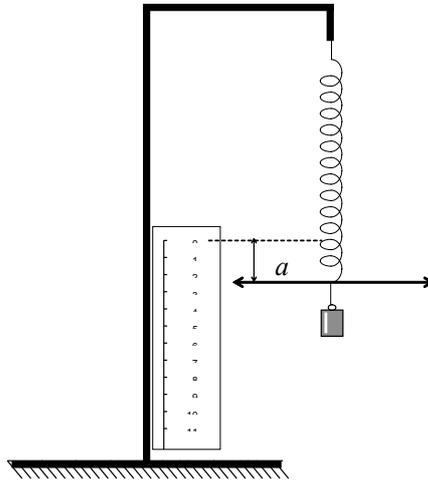
Utiliser le dispositif précédent, ajuster l'index du ressort au zéro du réglet, accrocher les différentes masses marquées à l'extrémité libre du ressort, noter les allongements  $a$  pris par celui-ci, dans le tableau ci-dessous.
