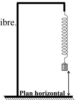
Pour cela régler la position du ressort de manière à laisser environ 10 cm entre la masse marquée et le plan horizontal.
