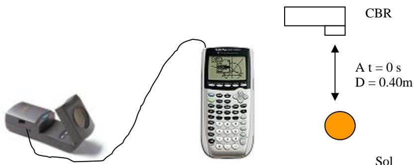
On abandonne sans vitesse initiale un ballon de basket placé à l'instant  $t = 0$  sous un capteur de mouvement à la distance  $e_0 = 40$  cm. Le capteur de mouvement va enregistrer à des intervalles de temps réguliers la distance qui le sépare du ballon.
